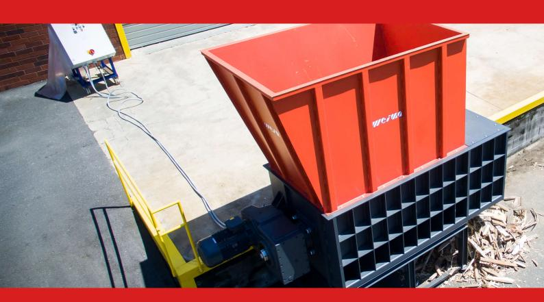
LARGE CAPACITY HOPPER - INTERCHANGEABLE CRUSHING TOOL IDEAL PRE-CRUSHER FOR BULKY WOOD WASTE
